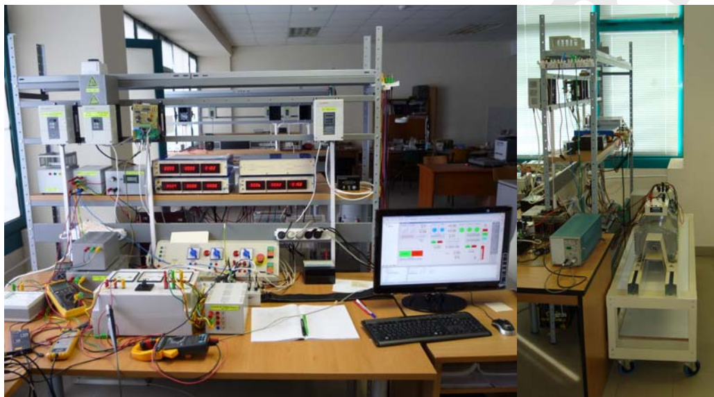
Фиг.9. Снимка на стенд за изпитване на синхронен генератор съвместно с електронните преобразуватели
