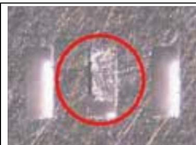
Фиг. 3. Снимка на дефект поради липсваща паста
