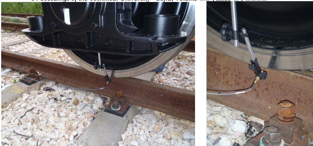
Фиг. 3-4 Постановка на втория вид измерване на шума при това изследване
