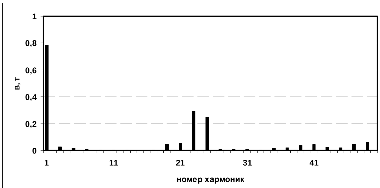
Фиг. 6. Хармоничен спектър на индукцията във въздушната междина при началното положение на ротора
