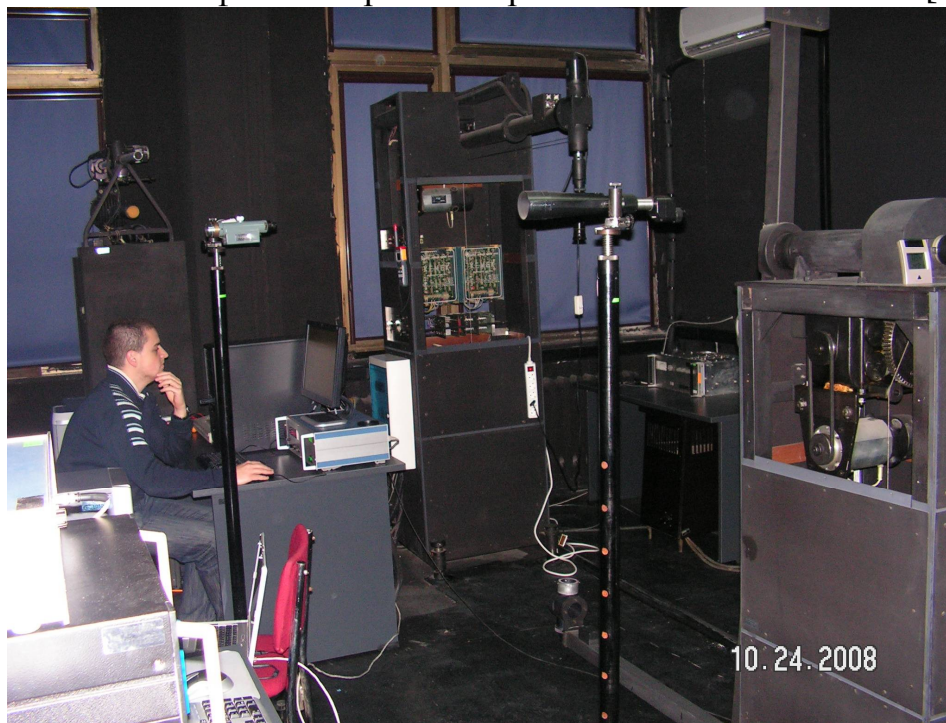
Фиг. 4. Гониофотометър за измерване на светлинен поток на НЦМ-България
