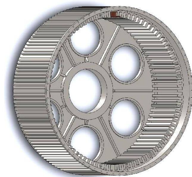
Фиг. 1. Статор на синхронен ветрогенератор с постоянни магнити в ротора /без котвена намотка/
