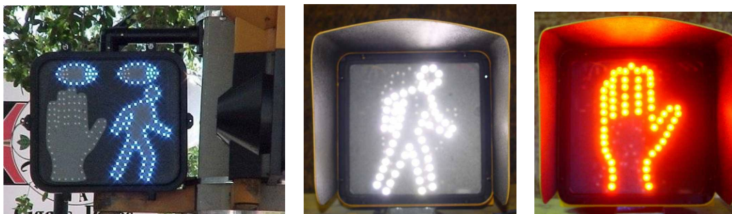
Фиг. 4. Светещи пулсиращи пътни знаци поставяни на пешеходни пътеки
