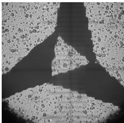
Фиг. 5. Тест за определяне качеството на фотомаските.
