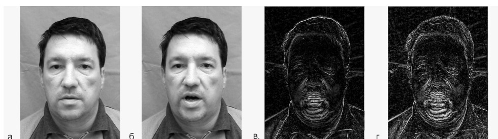
Фиг. 6. Използване на соларизация за определяне на местата на промяна и степента на промяна. а) неутрална позиция; б) обработвано изображение; в) резултат от изваждане на еднократно соларизирани изображения; г) резултат от изваждане на еднократно соларизирани изображения.
