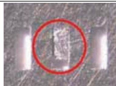
Фиг.3. Снимка на дефект поради липсваща паста
