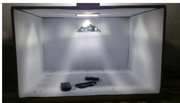
Фиг.13. Изследване разпределението на осветеностите на пода на помещението при бели и кафяви стени под и таван и пирамида с ъгъл на страната 45^\circ и 60^\circ
