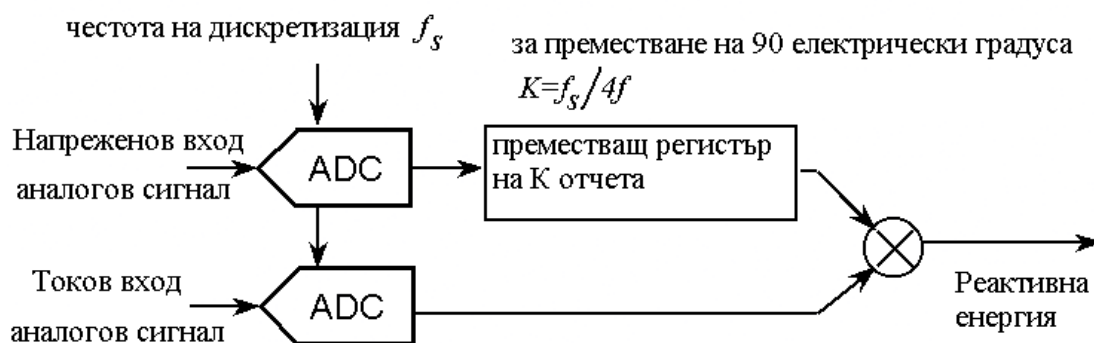
Фиг.5. Метод на „дефазиране на четвърт период”.
