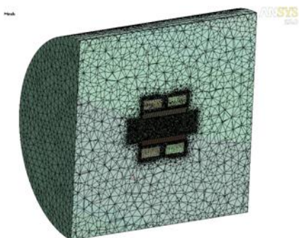
Фиг.5. Пълен 3D модел
