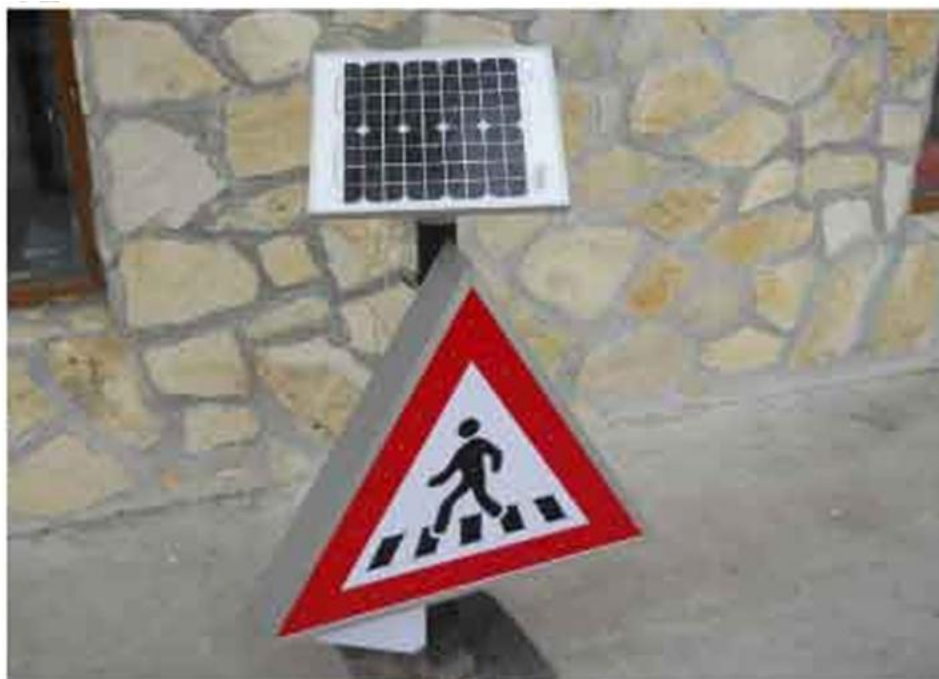
Фиг.7. Разработеният макет на сигнален светещ знак A18 със светодиоди и автономно захранване
