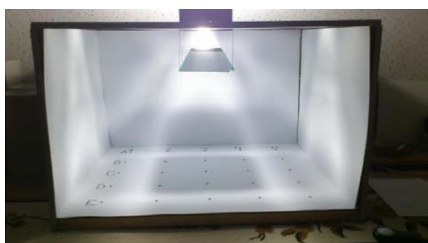
Фиг.13. Изследване разпределението на осветеностите на пода на помещението при бели и кафяви стени под и таван и пирамида с ъгъл на страната 45^\circ и 60^\circ
