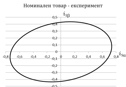
Фиг.11. Елиптично магн. поле при празен ход (резистори 100 \Omega )
