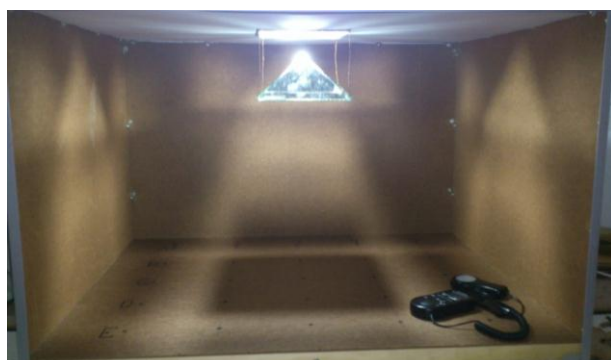
Фиг.12. Изследване разпределението на осветеностите на пода на помещението при кафяви стени под и таван и пирамида с ъгъл на страната 45^\circ и 60^\circ
