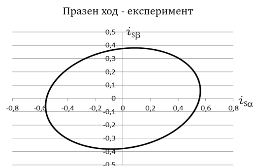
Фиг.11. Елиптично магн. поле при празен ход (резистори 100 \Omega )
