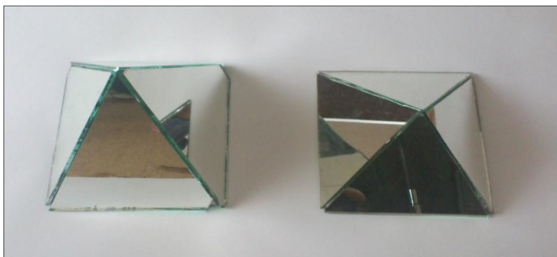
Фиг.11. Разработени модели на огледални рефлектори (пирамиди) с ъгли на страната на 45^\circ и 60^\circ за подобряване равномерността на осветеностите в помещение със светловодната шахта (фиг.11 и фиг.12)
