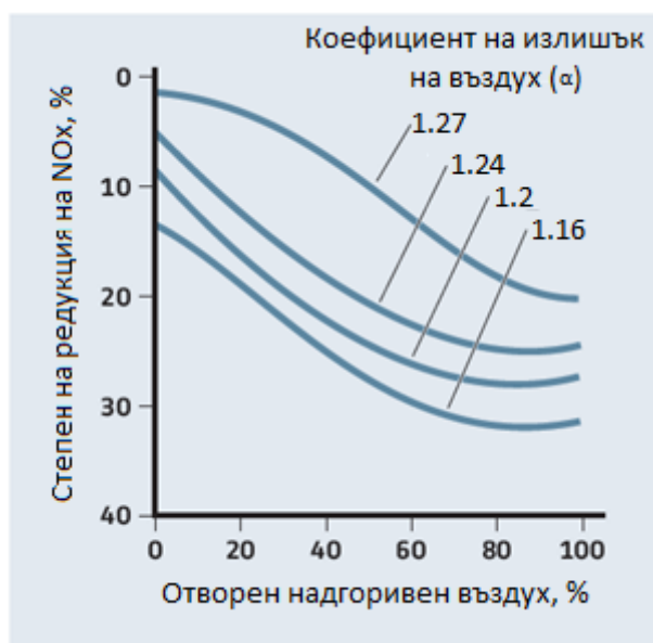
Фиг.3. Влияние на НГВ върху степента на редукция на азотните оксиди
