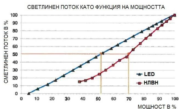
Фиг.3. Ефективност при димиране на осветители с НЛВН и със светодиоди (LED).
