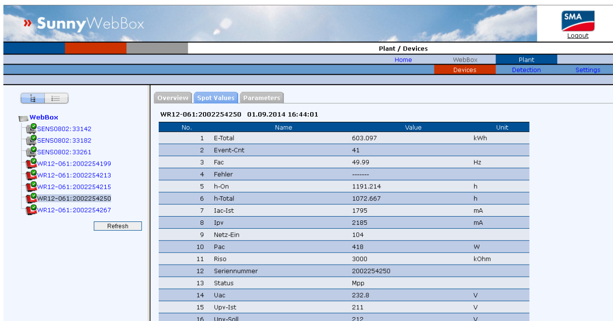
Фиг.7. Мрежова платформа на системата за събиране на данни Sunny Webbox.
