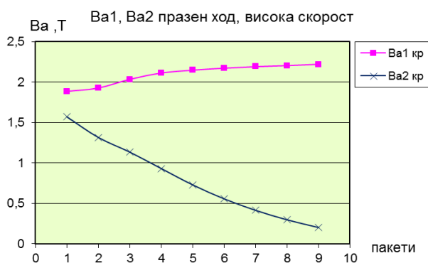
Фиг.12. Индукция в яремите по дължина на магнитопровода на двигател 3/0,55 kW при високата скорост
