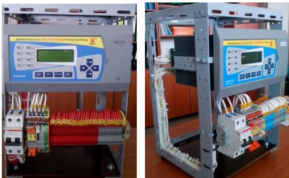
Фиг.2. Общ вид на изработените симулатори за изследване на ЦРЗ.
