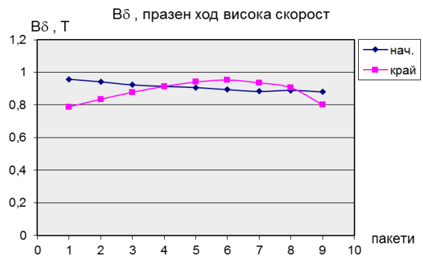
Фиг.3. Индукция във въздушната междина по дължината на магнитпровода при ниската скорост
