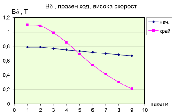
Фиг.8. Индукция във въздушната междина на двигател 3/0,55 kW при високата скорост
