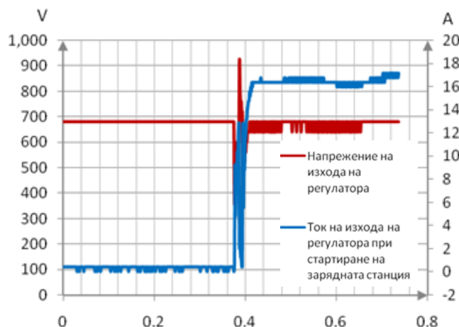
Фиг.10. Изходно напрежение на регулатора в режим на рекуперация и I_{3C}=200A .
