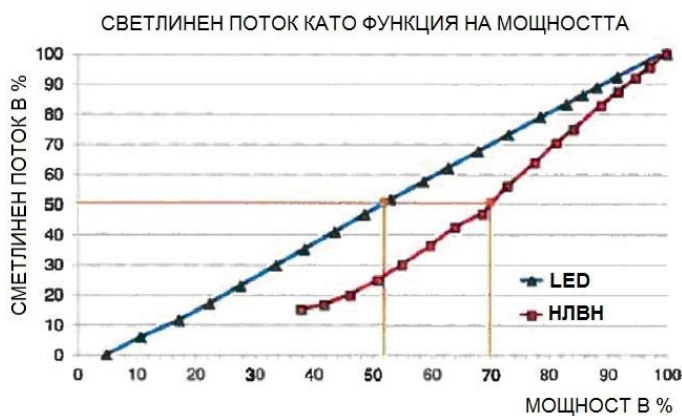
Фиг.1. Връзка между светлинен поток и подадена мощност при димиране на осветители със светодиоди (LED) и с НЛВН.
