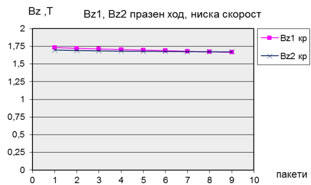
Фиг.5. Индукция в зъбите по дължина на магнитпровода при ниската скорост
