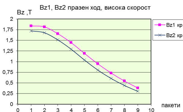
Фиг.10. Индукция в зъбите по дължина на магнитопровода на двигател 3/0,55 kW при високата скорост
