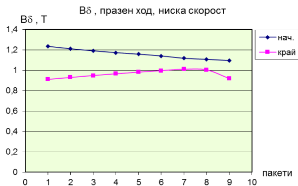
Фиг.9. Индукция във въздушната междина на двигател 3/0,55 kW при ниската скорост
