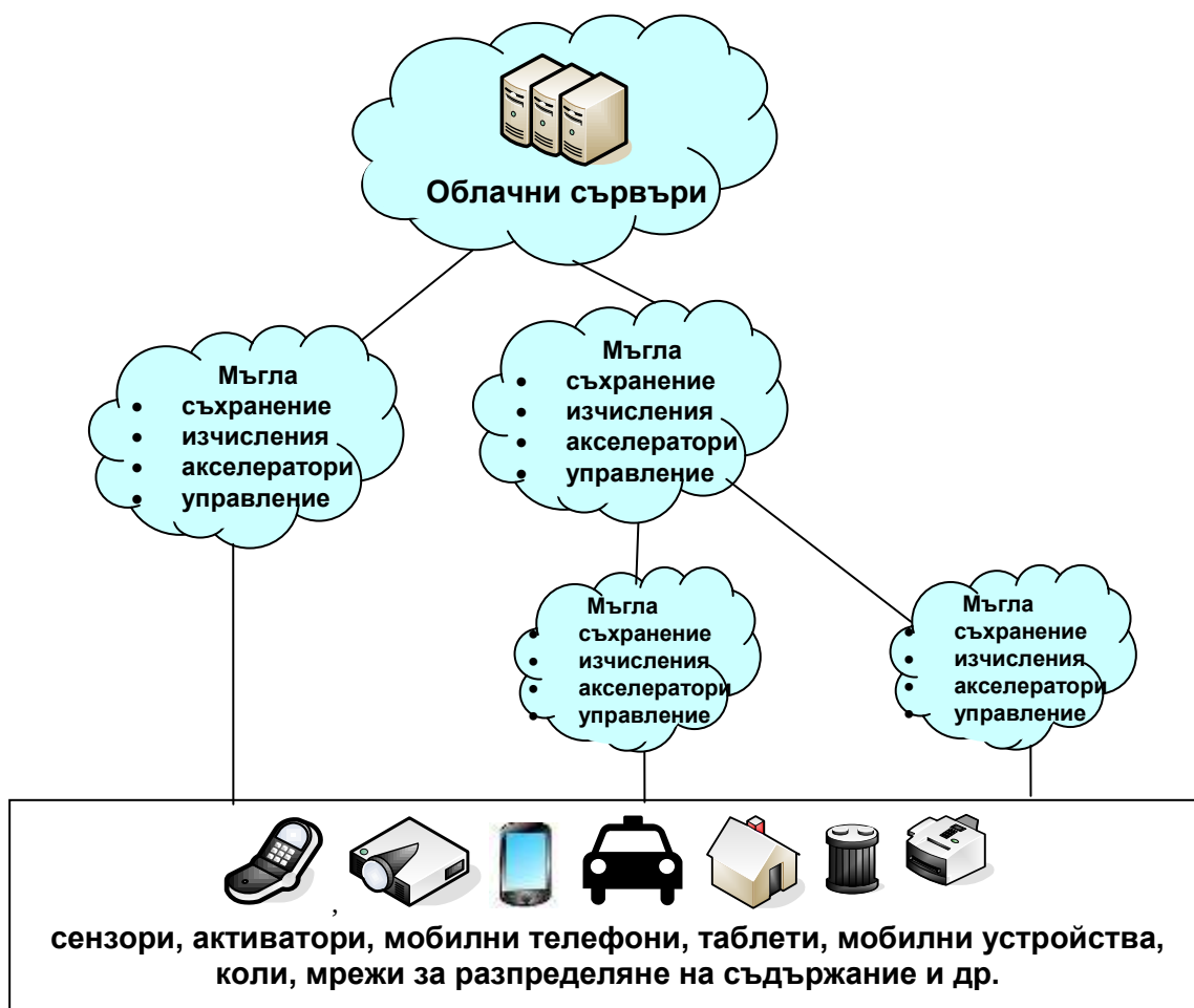
Фиг.2. Типична йерархична структура, базирана на изчисления в мъгла
