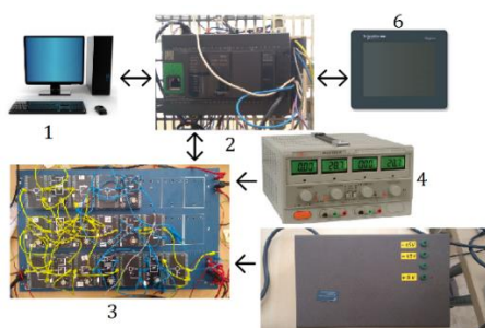
Фиг.14. Хардуерна част на системата за управление.
